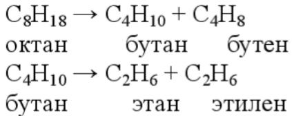
Такой процесс, осуществляемый при температуре около 470°C - 550°C и небольшом давлении, называется термическим крекингом. Этому процессу обычно подвергаются высококипящие нефтяные фракции, например мазут.
